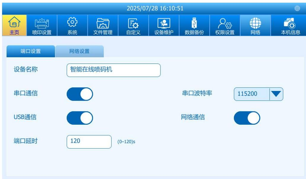
**端口设置：**设备名称、串口通信和波特率，启用或禁用 USB 和以太网连接，并根据需要设置端口延时。
