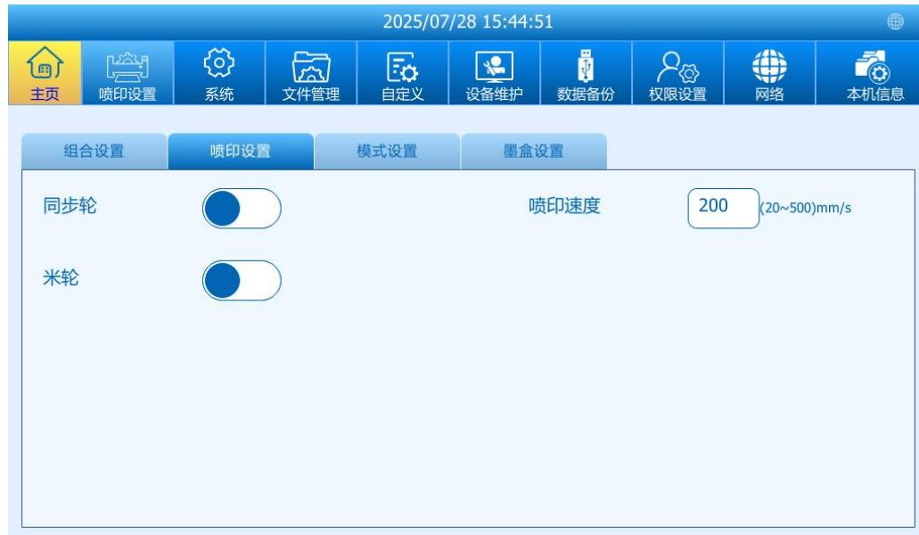
**同步轮：**默认关闭。启用后，同步轮会自动检测打印方向和速度。禁用后，您可以手动设置打印速度以匹配传送带速度（20-1000 毫米/秒）。
