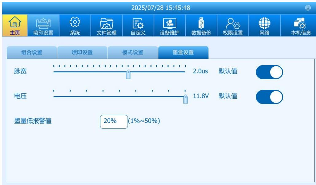
**脉宽和电压：**使用奔彩墨盒时，系统会根据墨盒芯片数据自动应用默认设置。对于第三方墨盒或自定义设置，您可以手动设置脉宽和触发电压。配置完成后，即使重启设备或重新插入墨盒，脉宽也保持不变。
