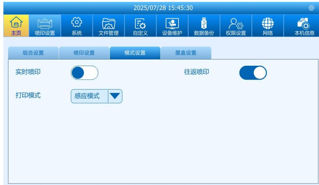
**实时喷印：**启用此功能可与传感器信号同步打印当前时间（例如时间戳或生产日期）。这可确保每个产品在通过传感器时接收准确、可追溯的时间数据。
