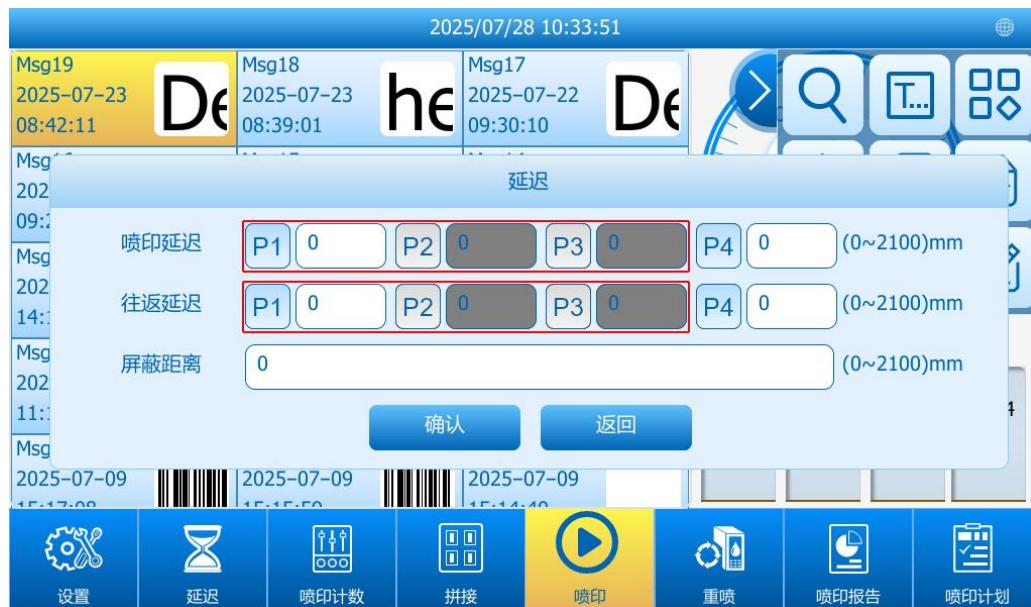
**往返延迟：**启用此功能可使打印头在正向和反向之间交替移动。它会先按设定方向打印一次，然后按相反方向打印一次，如此循环。
