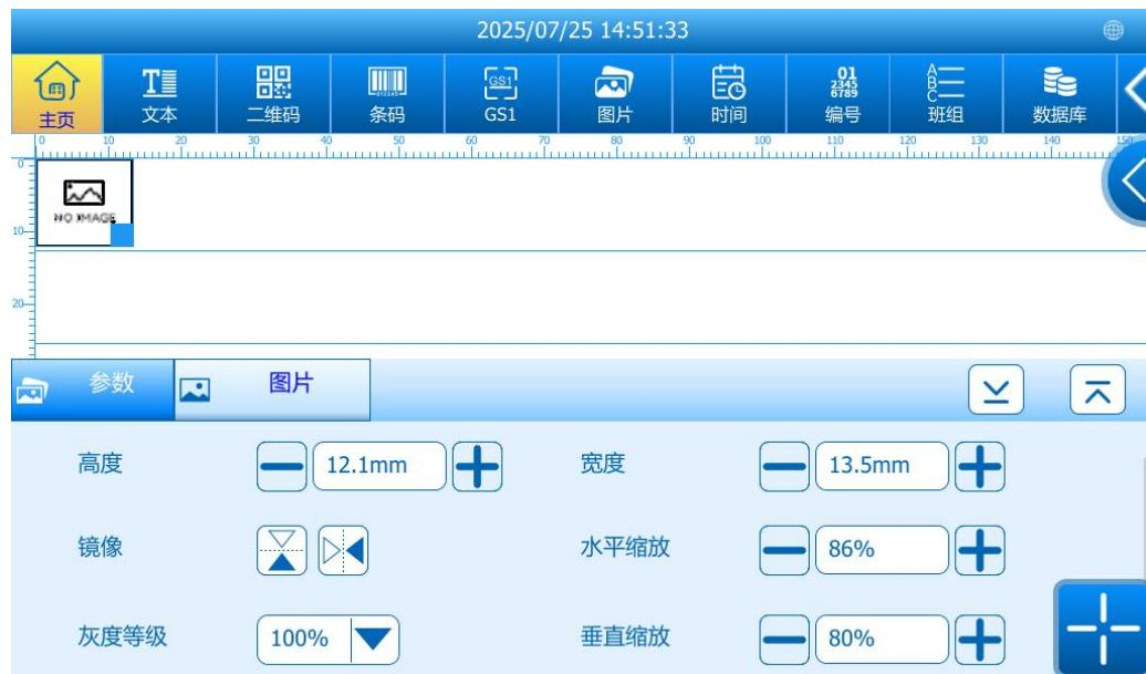
**宽度：**默认为 15.5 毫米，可调范围为 1.5 至 46.7 毫米。手动输入数值或使用  $\pm$  按钮（步长：10；长按快速调整）。
