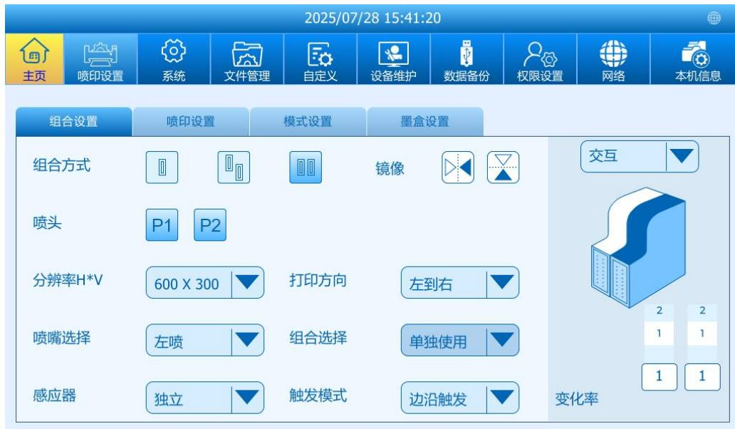
**双色:** 使用两个不同颜色墨水的喷头, 以两种颜色打印同一条信息。将内容拆分到每个喷头的编辑窗口之间, 设置和调整间距, 并保持打印对象位置一致, 以实现精准对齐。
