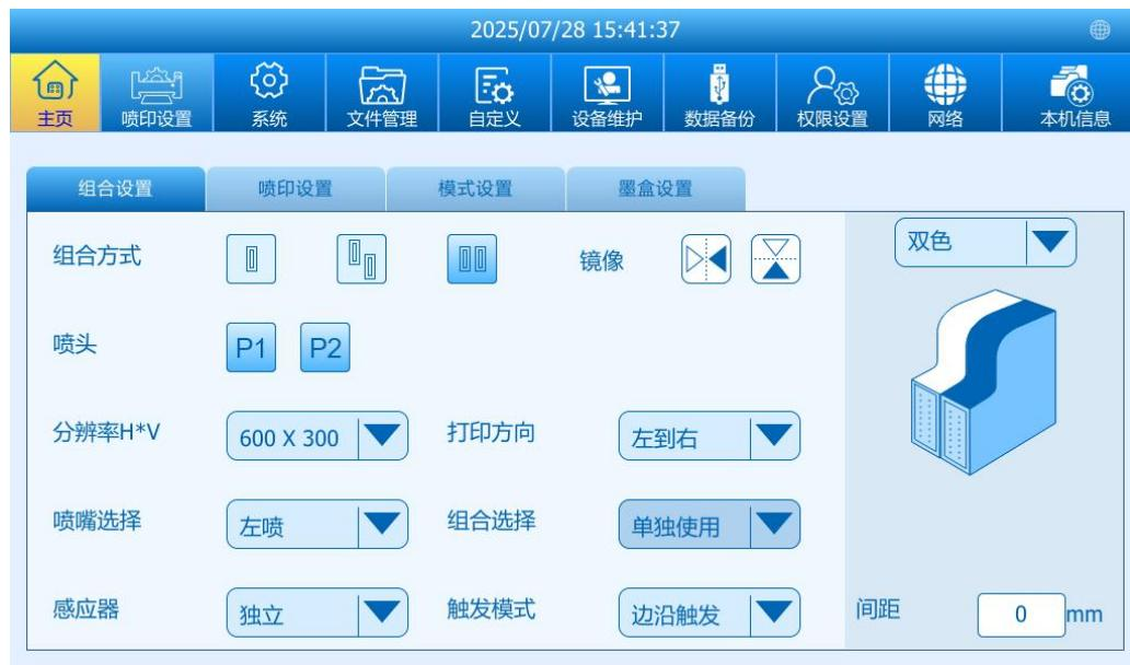
**镜像：**配置打印头的图片方向。选项包括水平和垂直镜像，以便根据需要调整打印方向。
