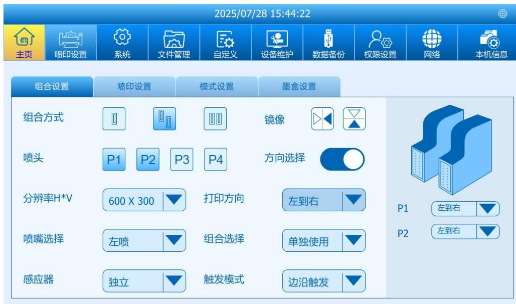
**分辨率 (水平\*垂直)**: 设置水平和垂直打印分辨率。默认值为 600 DPI (水平) × 300 DPI (垂直)。
