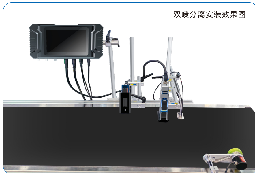
双喷拼接加接线盒模组安装效果图
